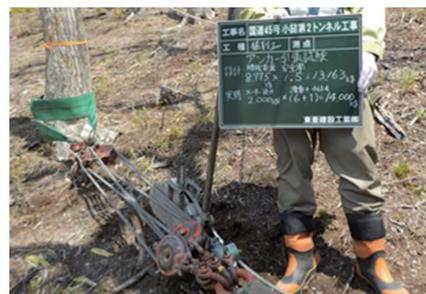
写真2: 生立木使用のアンカー引張試験
